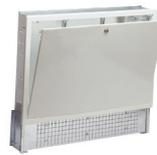
**Art. 197** - Cassetta per impianti di riscaldamento sottopavimento con serratura. È possibile regolare l'altezza della cassetta (da 630 a 930 mm) e la profondità (da 110 a 130 mm). È possibile regolare la posizione interna del collettore tanto in altezza quanto lateralmente. Consente di alloggiare collettori con pompa di circolazione.
