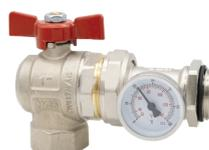
**Art. 226** - Valvola a sfera a passaggio totale a squadra con attacco girevole portatermometro, unione al collettore con bocchettone a sede piana e termometro (termometro art. 206 0-60° incluso). Filettatura ISO 228.
