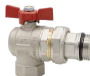
**Art. 225** - Valvola a sfera a passaggio totale a squadra con bocchettone con tenuta O ring al collettore. Attacco del bocchettone alla valvola a sfera con guarnizione a sede piana. Filettatura ISO 228.
