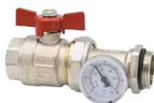
**Art. 216** - Valvola a sfera dritta a passaggio totale con attacco girevole portatermometro, unione al collettore con tenuta O ring (termometro art. 206 0-60° incluso). Filettatura ISO 228.
