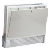
**Art. 196** - Cassetta per impianti di riscaldamento sottopavimento con serratura. È possibile regolare l'altezza della cassetta (da 630 a 930 mm) e la profondità (da 90 a 110 mm). È possibile regolare la posizione interna del collettore tanto in altezza quanto lateralmente. Per collettori senza pompa di circolazione.
