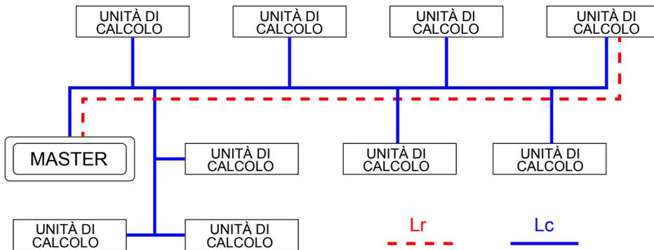
Il concentratore M-Bus è un dispositivo che può essere utilizzato come convertitore di livello e come display remoto con tastiera o telecomando. Il concentratore offre la possibilità di leggere in automatico tutte le letture dei contatori collegati alla rete M-Bus e raccogliere i dati nella memoria flash del dispositivo.
