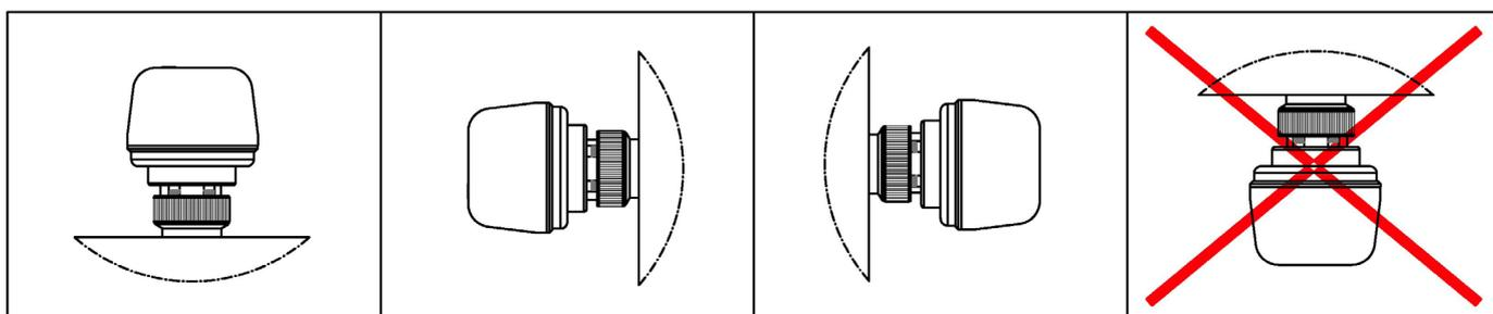
Si consiglia l'installazione degli attuatori elettrotermici in posizione orizzontale o verticale, mai rovesciata! La possibile formazione di condensa sulle valvole e sui collettori potrebbe scendere sul comando e danneggiarlo.
